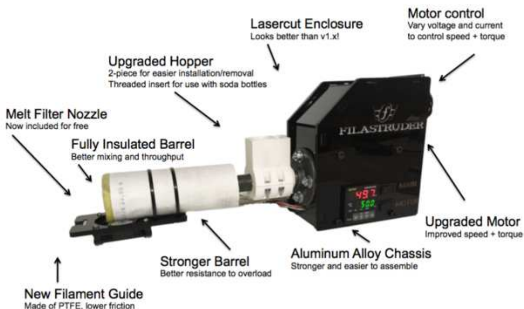
Figura 9. Extrusora para fabricar filamento a partir de PLA reciclado "Filastruder"
