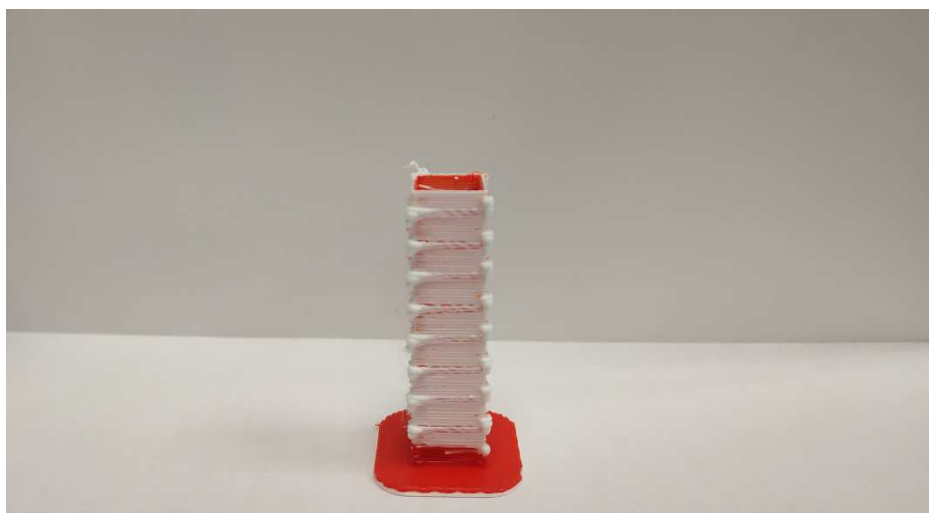
Figura 18. Torre auxiliar de purgado de material
