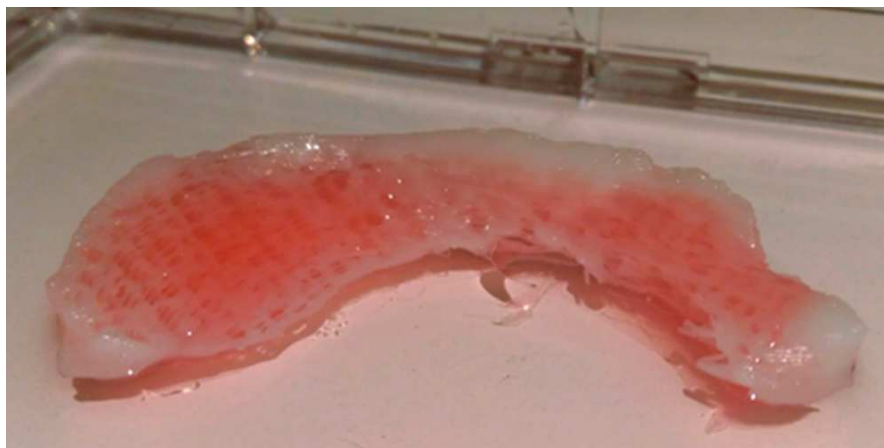
Figura 3. Estructura realizada combinando tejido humano con PCL biocompatible creada mediante FDM
