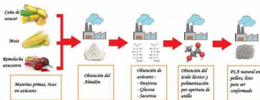
Figura 6. Esquema de la obtención de PLA
