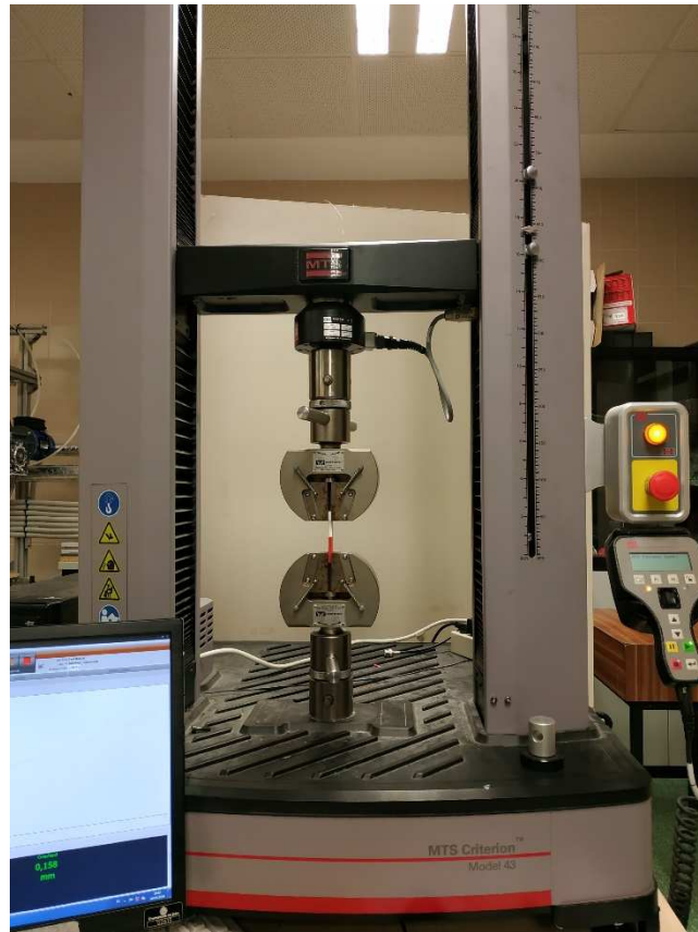
Figura 22. Detalle de la probeta fijada en la máquina de ensayo
