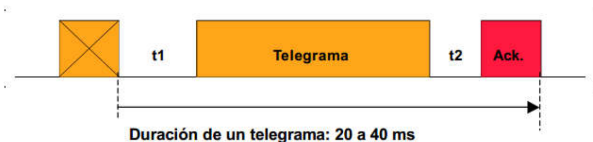
Ilustración 16: Secuencia de envío de trama ante la activación de un evento
