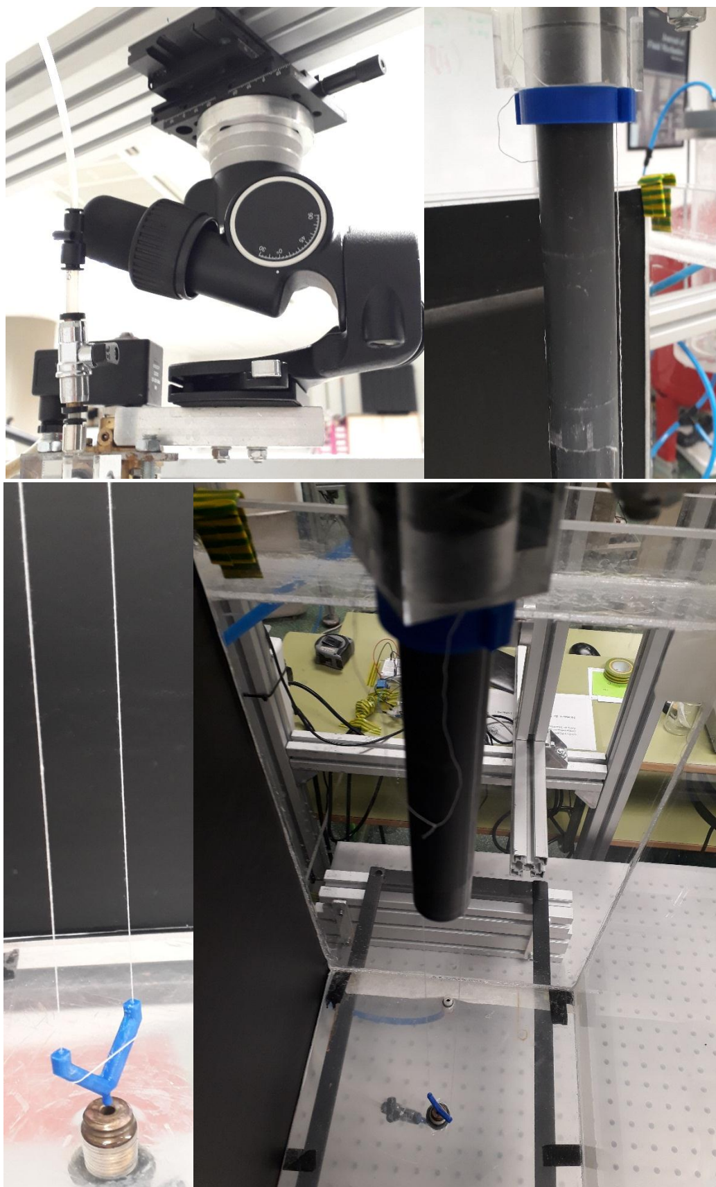
Ilustración 4.9 Soporte de calibración y sistema de aplomado. (Autor)
