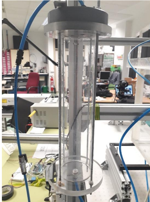
Ilustración 4.5 Depósito presurizado (autor)
