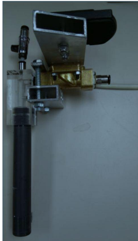
Ilustración 4.7 Conjunto de electroválvula, codo 90°, conducto de salida y purgador. (Linares Ureña, 2017)
