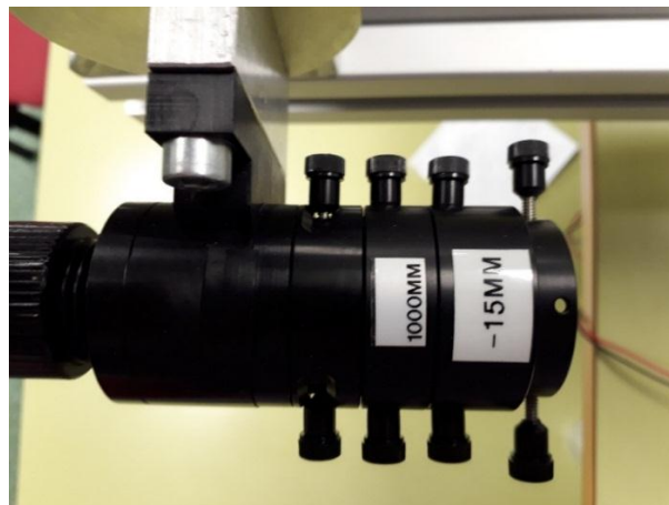
Ilustración 5.5 Configuración de lentes en la salida del láser (autor)
