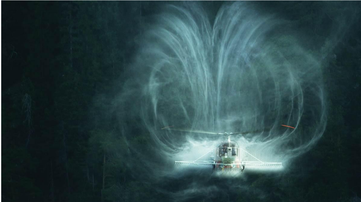
Ilustración 1.3 Helicóptero con aspersores de agua para visualizar las líneas de corriente durante vortex ring state , (AERIALSTAGE, s.f.).
