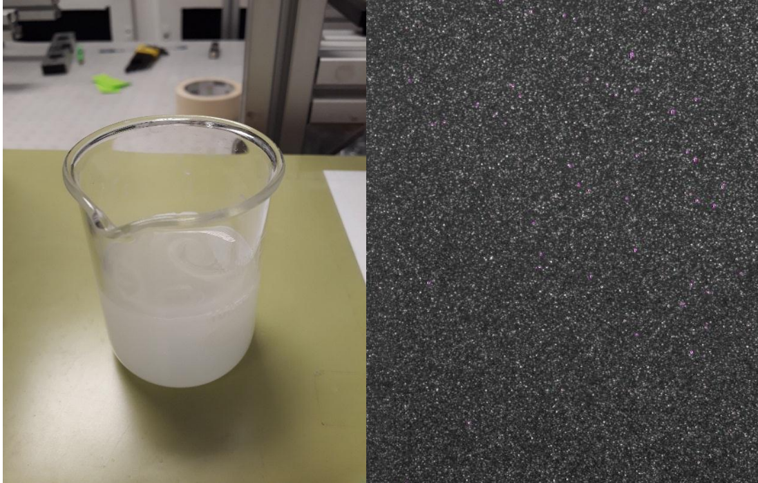
Ilustración 5.2 Partículas mezcladas antes de añadir a la urna (izq.). Imagen de las partículas tomadas con el sistema PIV (drcha.) (autor)
