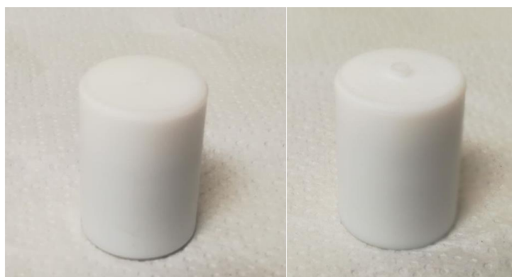
Figura 3. 17 Orificio Teflón, D_i = 1 \text{ mm} y Tobera Teflón, D_i = 1 \text{ mm}
