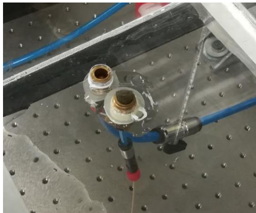
Figura 3. 10 Salida del aire donde situamos la tobera o el orificio
