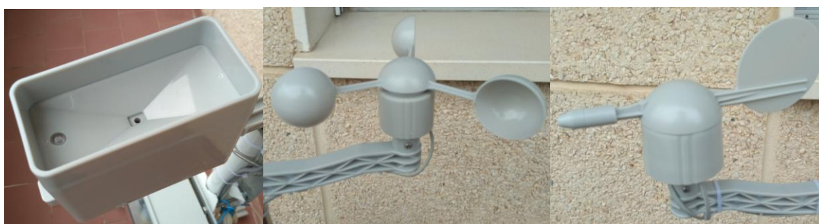
Figura 5.2.5.6. Sensores: pluviómetro, velocidad y dirección del viento.
