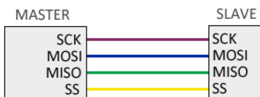
Figura 5.2.1.3. Estructura del bus SPI
