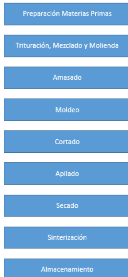
Figura 5.- Proceso de conformación de materiales cerámicos.
