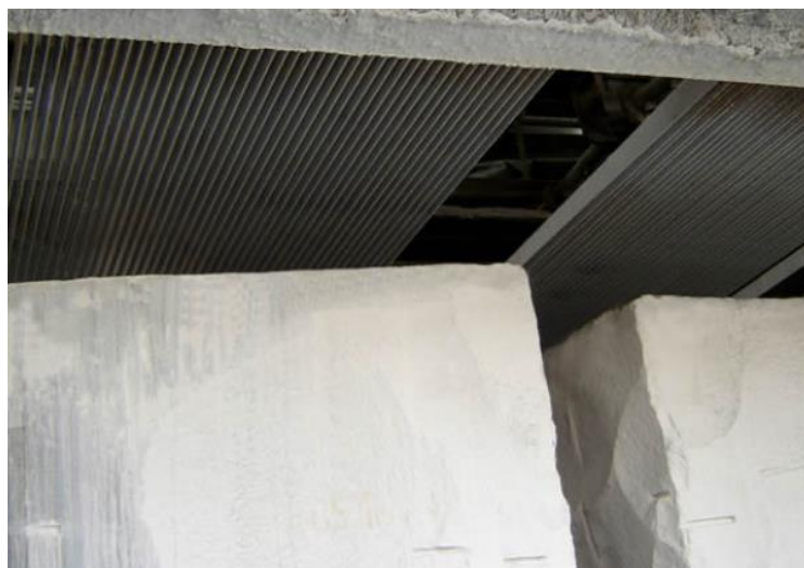
Imagen 4.3: Carga situada dentro del telar y lista para la bajada.
