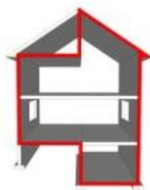
Figura 2.2 Esquema de los componentes de la envolvente térmica
