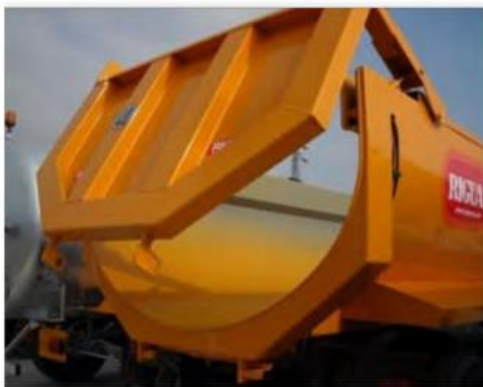
Bañera CIL750 detalle puerta mecánica Automática.
