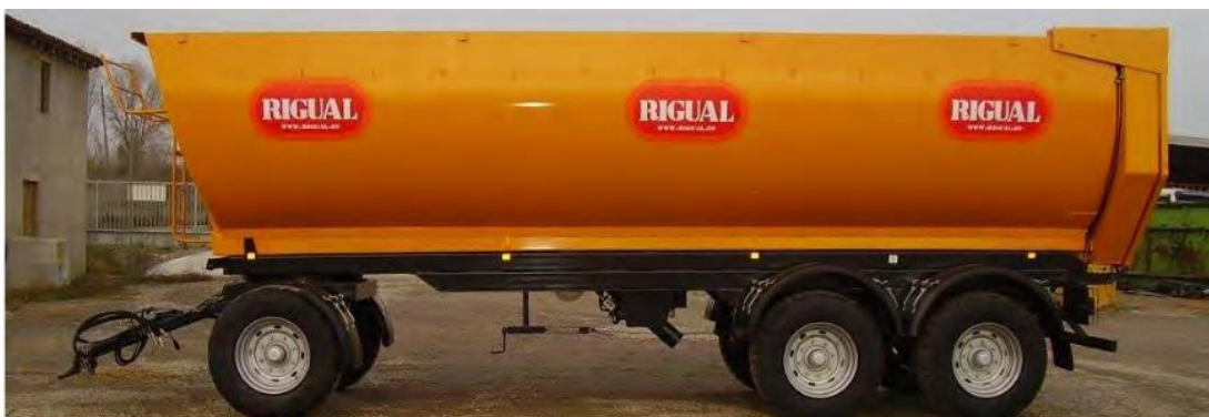
Figura 28. Bañera agrícola cilíndrica para el transporte del cereal ensilado a la planta. Fuente: [54]
