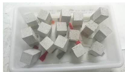
Figura 3.9. – Ensayo de Absorción
