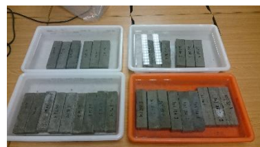
Figura 3.7. - Probetas en recipiente de curado
