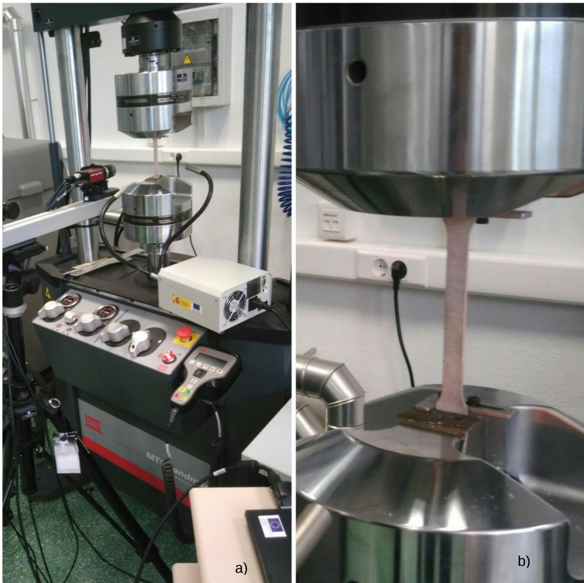
Figura 3.7. Ensayo monotónico de tracción montado (a) y probeta ajustada en mordazas (b)
