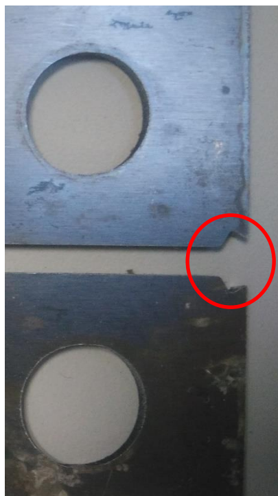
Figura 4.7. Ranura para extensómetro en probeta CT
