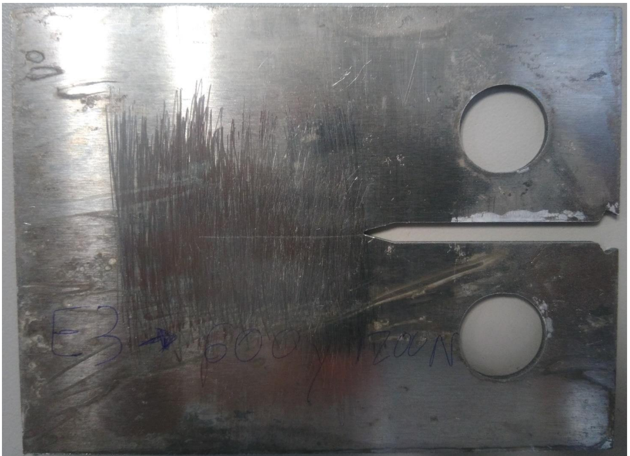
Figura 4.9. Grieta en probeta CT
