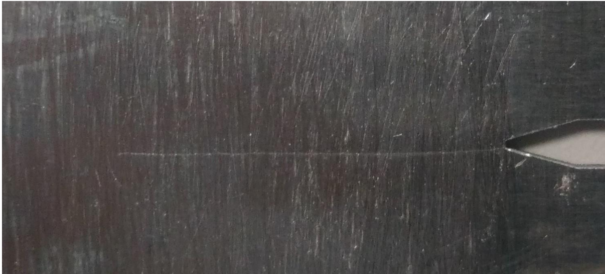
Figura 6.1. Trayectoria de la grieta
