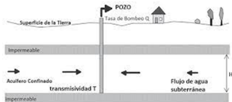
FIGURA 1. Esquema de un acuífero confinado bombeado. Modificado de Holzbecher (2007).
