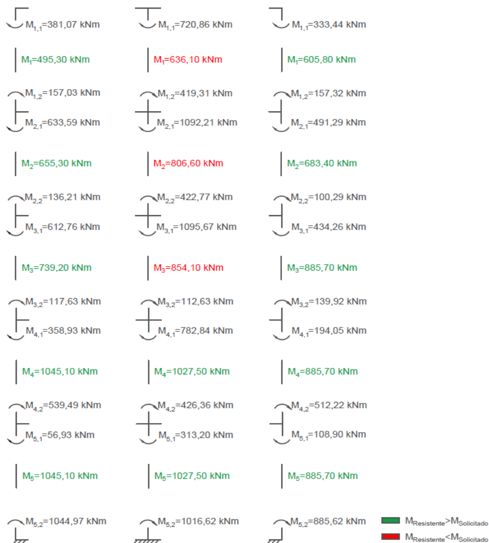
Fig. 41. Análisis por planta del momento resistente y solicitado en cada pilar
