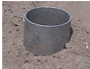
Figura 5. Cilindro Kopecky para la recogida de muestras (Lázaro Sánchez et al., 2010)
