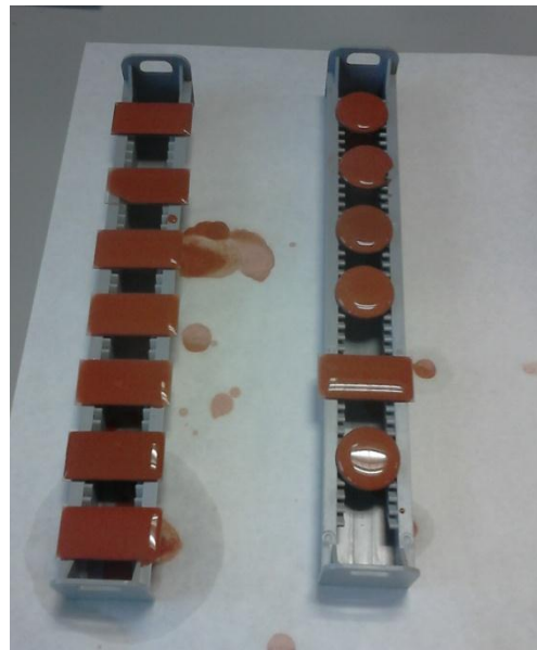
Figura 4. Proceso de secado a temperatura ambiente de los agregados orientados.
