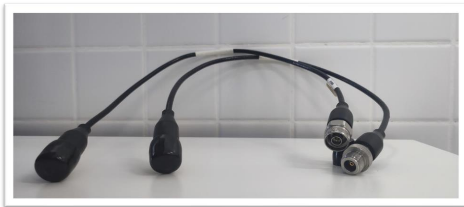
34. Cableado con conectores tipo N (macho y hembra).
