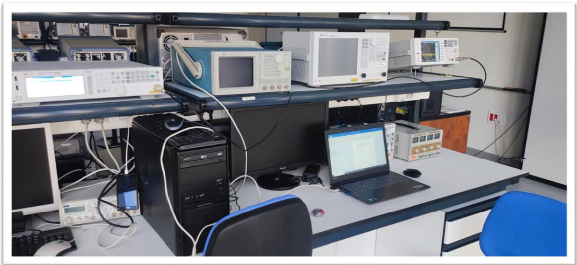
59. Conexión entre equipos para ver señal generada y enviada. Caso 1.
