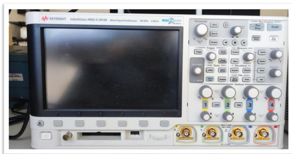
64. Conexiones disponibles en panel frontal MSO-X 3014A.
