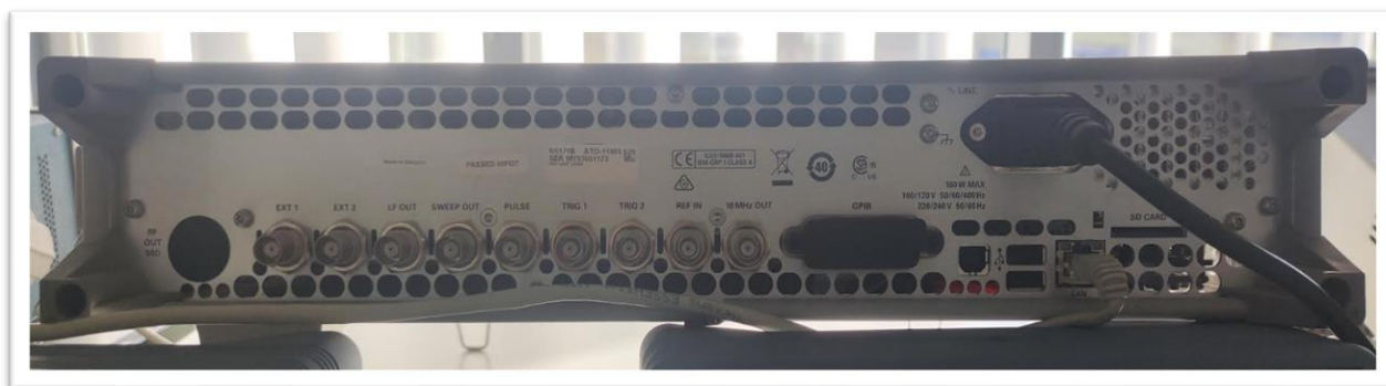
21. Interfaces de conexión del N5171B.
