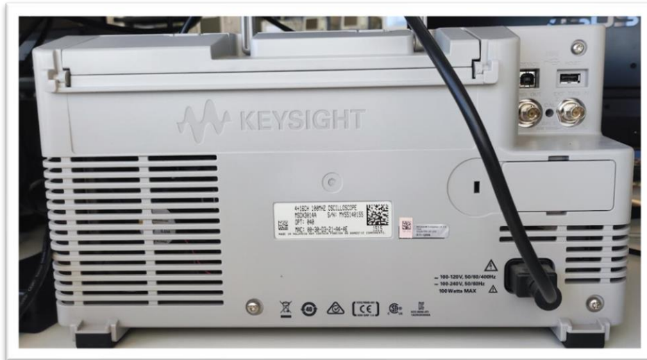
65. Conexiones disponibles parte trasera MSO-X 3014A.
