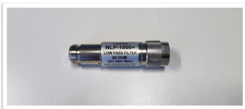
28. Filtro paso bajas con frecuencia de corte a 900MHz.
