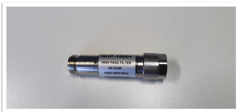
30. Filtro paso altas a frecuencia 1000-3000 MHz.
