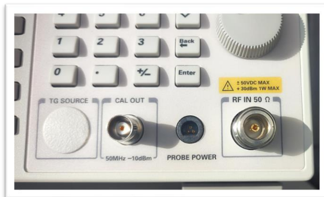
23. Entrada RF tipo N del N9320B.
