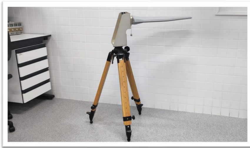
25. Antena Yagi-Uda con radomo protector.
