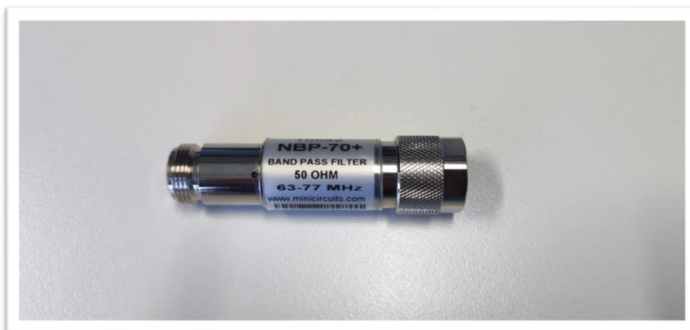
29. Filtro paso banda entre 63-77 MHz.
