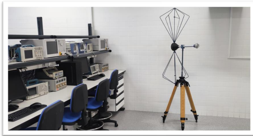
26. Antena bicónica montada en un trípode (soporte).
