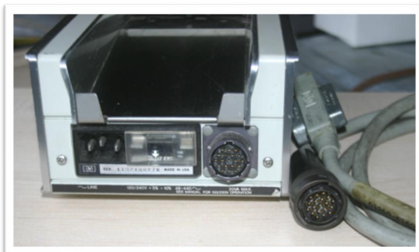
1. GPIB conector físico redondo.[2]
