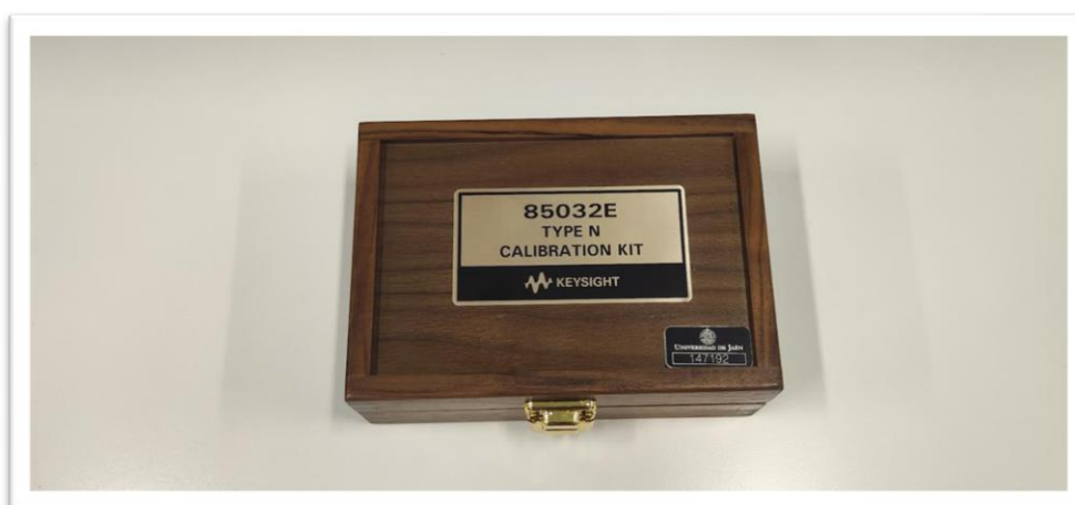
31. Kit de calibración compatible con VNA E5063A.
