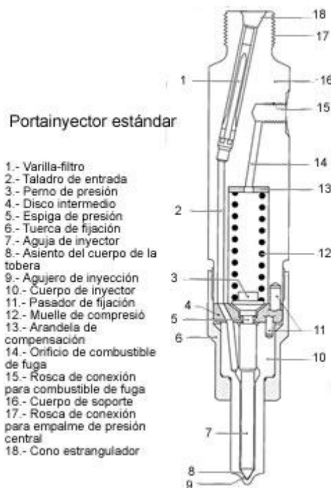
Figura 1.9. Esquema de la estructura portainyector estándar
