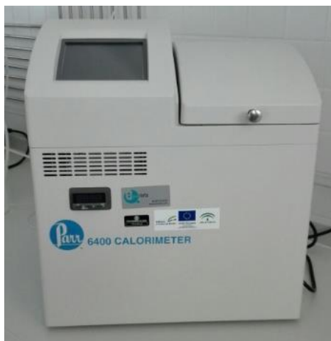
Figura 34 - Bomba calorimétrica empleada.
