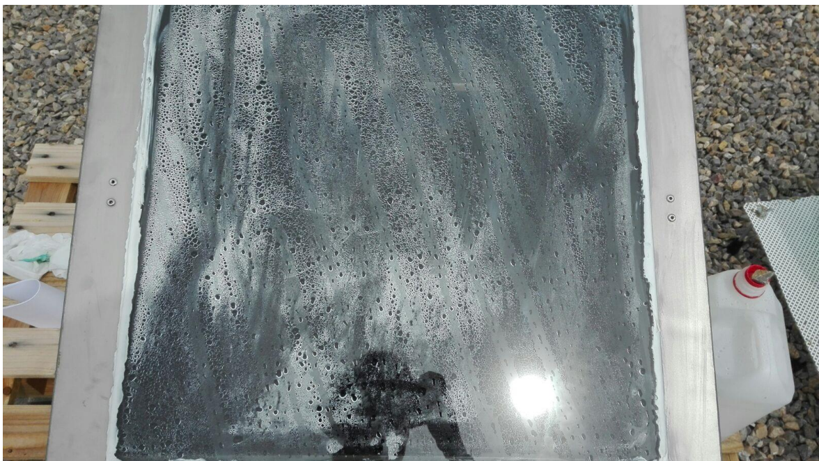
Figura 43 - Condensación de agua sobre cristal utilizando líquido hidrofóbico.
