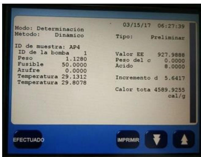
Figura 35 – Ejemplo valores PCS en bomba calorimétrica. Servicios técnicos Campus científico tecnológico de Linares.
