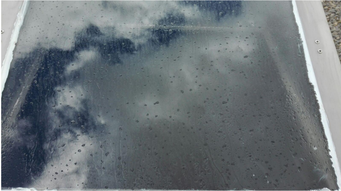
Figura 42 – Condensación de agua sobre cristal sin uso de líquido hidrofóbico.
