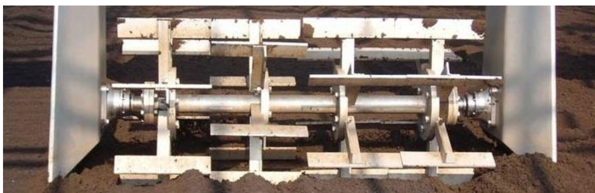
Figura 57 - Mecanismo de agitación del gestor de lodos.[23]
