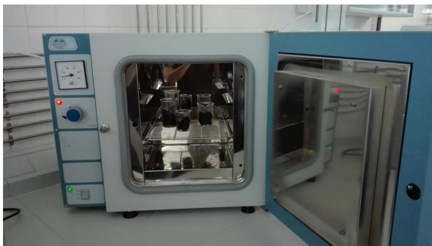
Figura 33 - Muestras en horno mufla de temperatura regulable.
