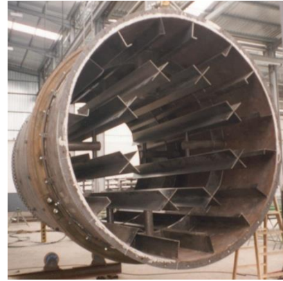
Figura 11 - Interior del tromel
