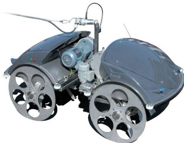
Figura 54 - Topo eléctrico desarrollado por Thermo-System.[22]
