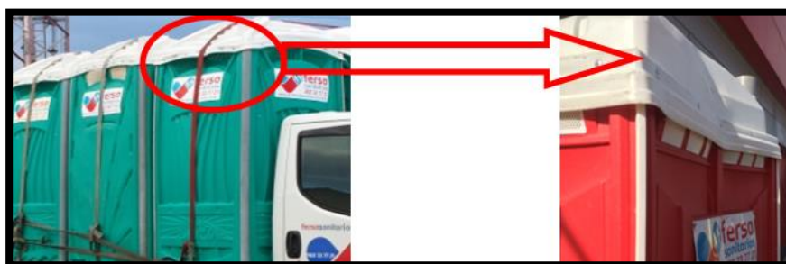
Figura 3.6: Abolladura en cabina por mal cinchado. (Fuente: Autor)
