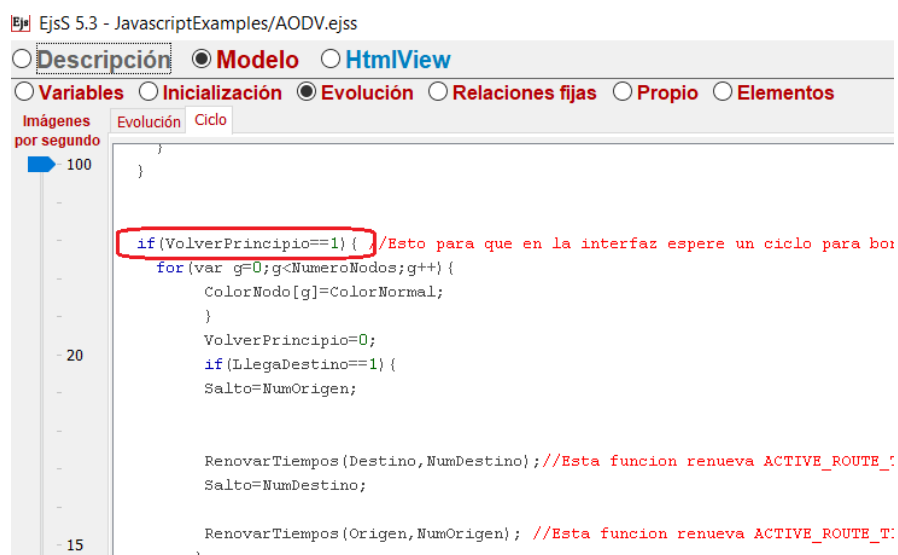
Ilustración 85: Definición del método utilizado para renovar los tiempos de las rutas utilizadas para el envío de datos entre nodos. Fuente: Propia
