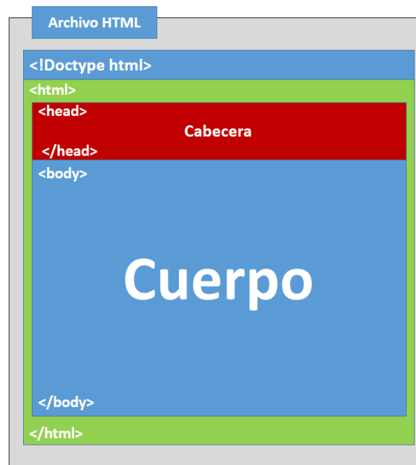
Ilustración 5: Estructura básica de un documento en HTML. Fuente: https://studentplace98.blogspot.com/2019/04/EstructuraBasica.html
