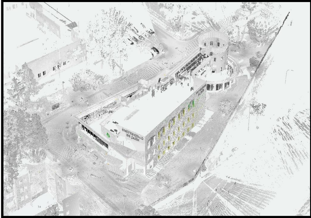
Ilustración 24. Nube de puntos generada del edificio Zabaleta
