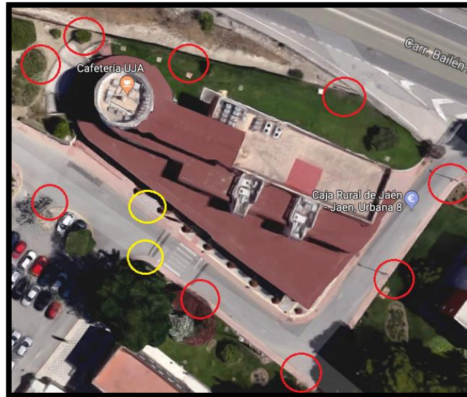
Ilustración 16. Distribución de estacionamiento del láser escáner.
