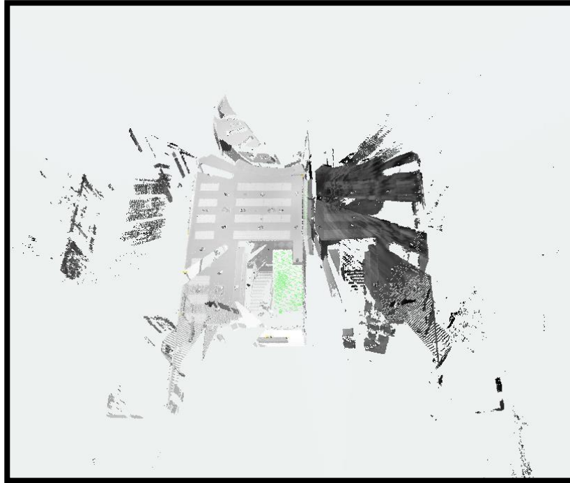
Ilustración 25. Artefactos generados a causa de las ventanas.
