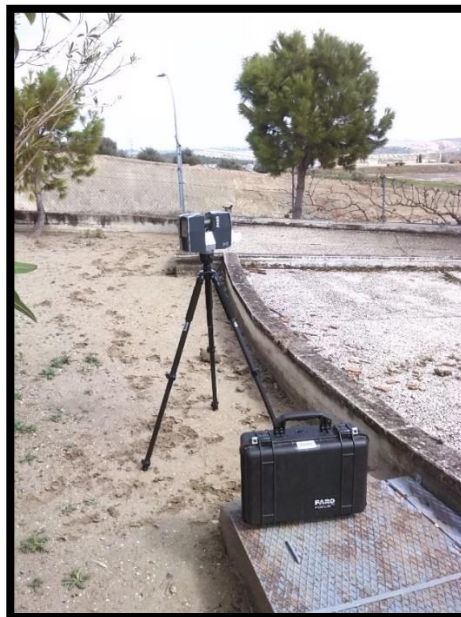
Ilustración 11. Estacionamiento del láser escáner.
