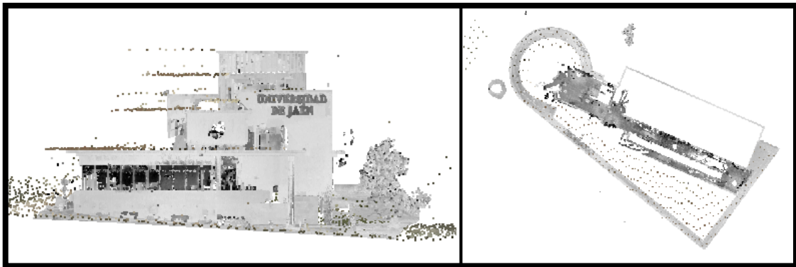
Ilustración 46. Ajuste de la superficie de puntos al modelo.
