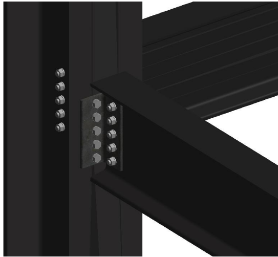
Figura 47. Vista 3D de la conexión pilar-viga.
