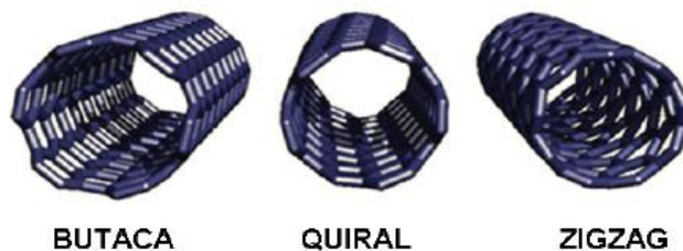
Figura 5. Representación idealizada de los tipos de SWCNTs, sin defectos y con los extremos abiertos.
