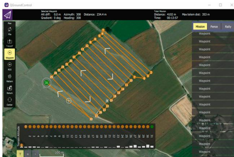
Figura 4.1 Planificación de vuelo con programa “QGroundControl” de un RPAS (Ahmed et al., 2020)
