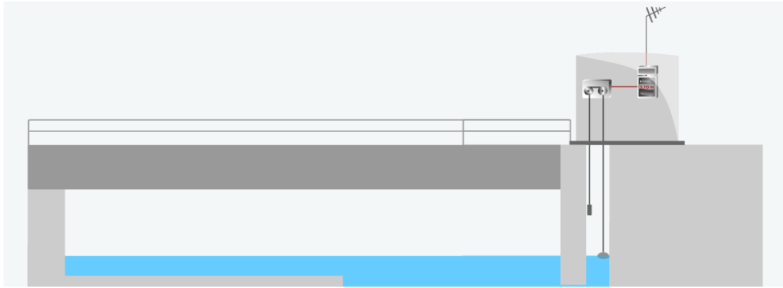
Ilustración 13. Esquema Ilustrativo de una Estación de Aforo
