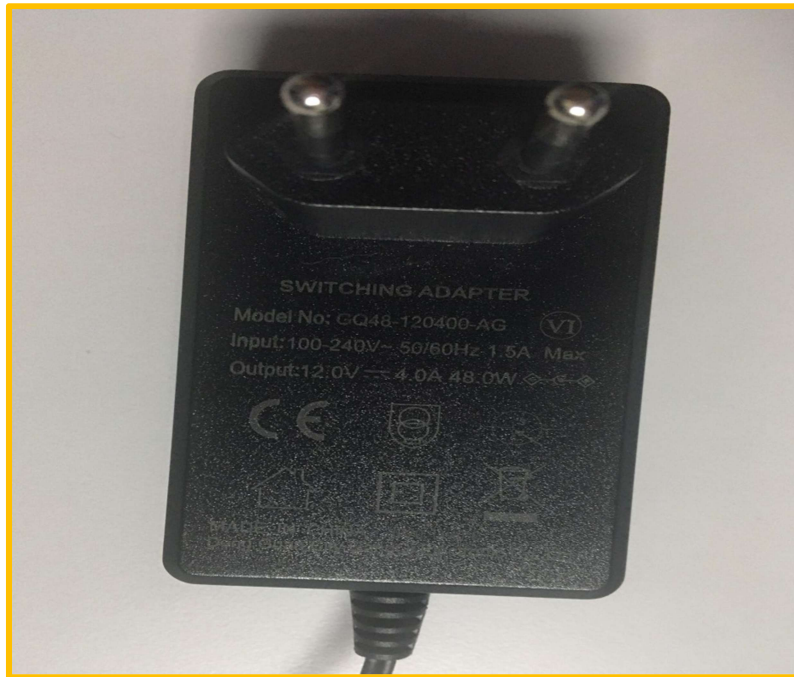
Figura 73. Fuente de alimentación para el modulo láser con salida de 12 V / 4 A
