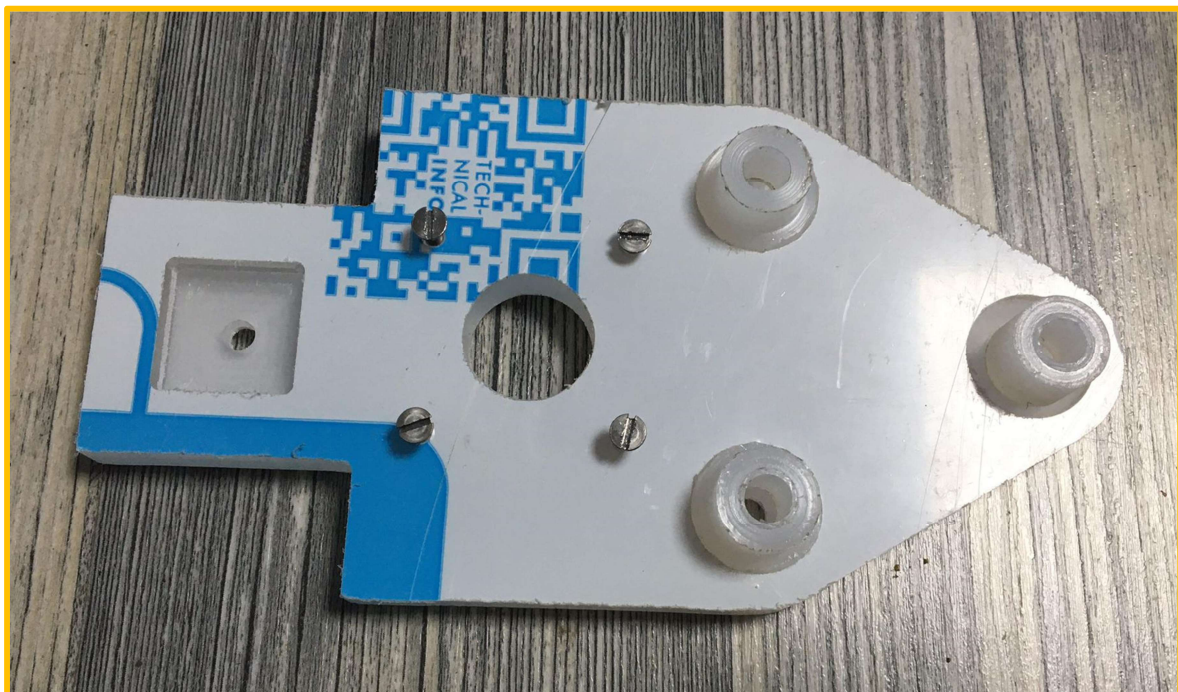
Figura 38. Colocación de los separadores en la pieza del soporte
