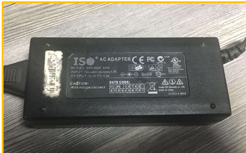
Figura 72. Fuente de alimentación para los motores con salida de 12 V / 5 A
