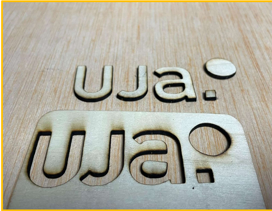
Figura 90. Resultado final del corte láser en madera
