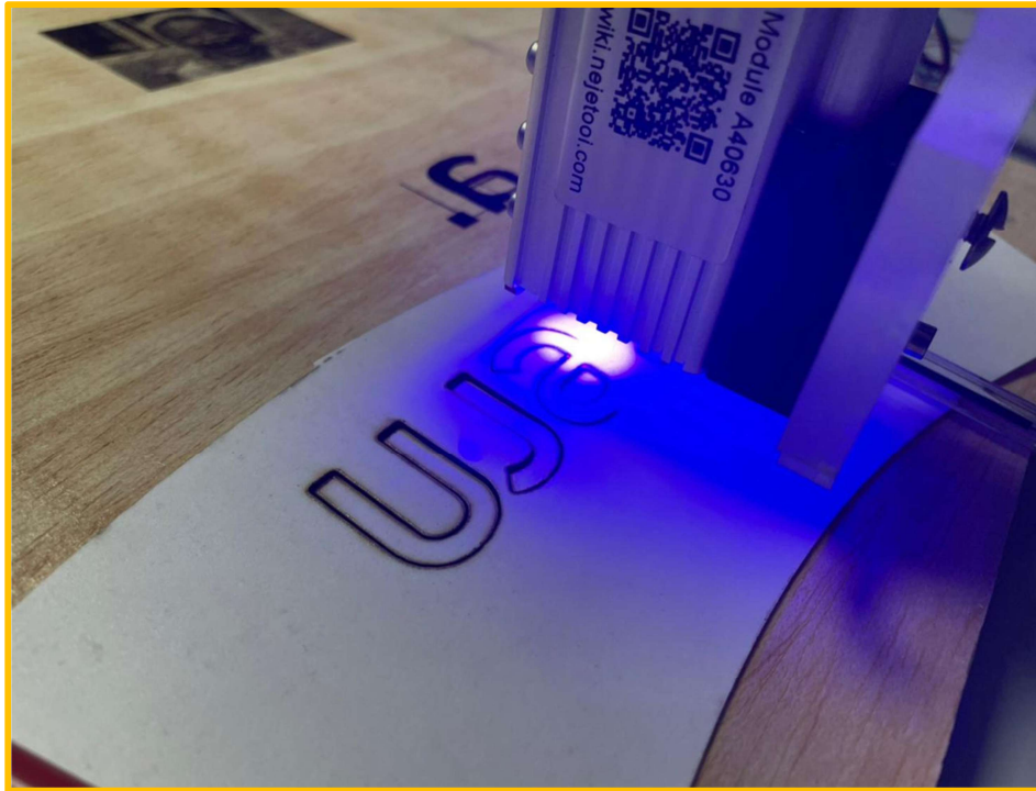
Figura 82. Proceso del corte láser en papel
