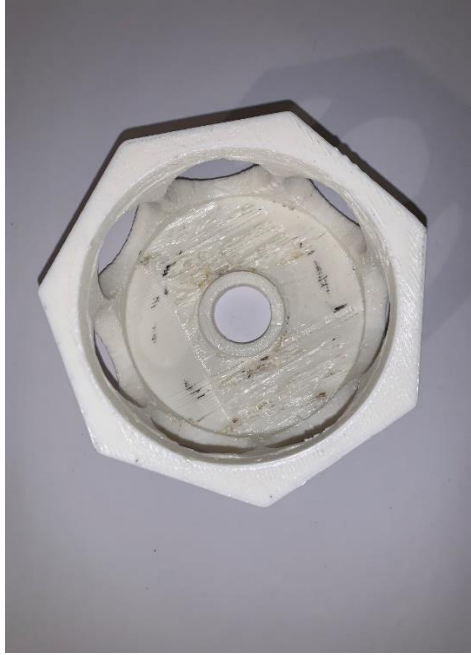
FIGURA 9.8: en esta figura se aprecia el cuerpo del motor, y se observan las imperfecciones comentadas anteriormente.
