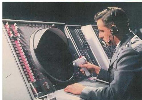
FIGURA 4.3: imagen del SAGE primer sistema grafico que localizaba objetos vía radar y los mostraba en una pantalla. (15)
