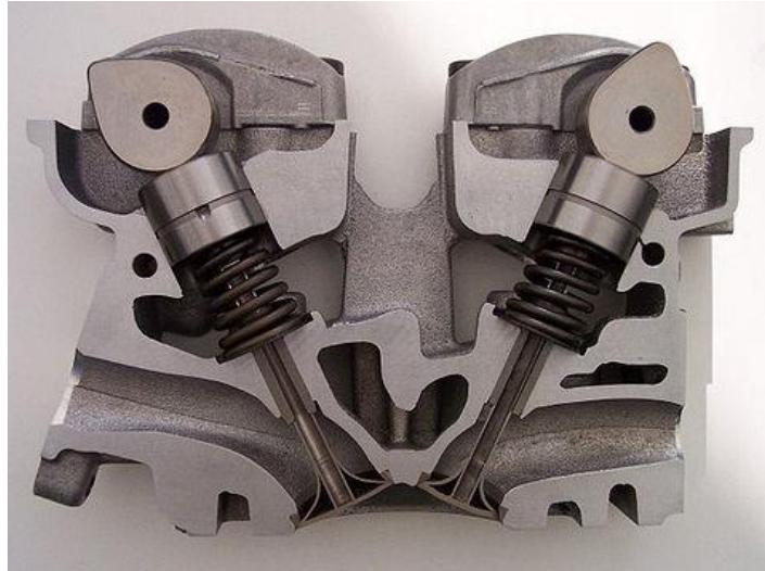
FIGURA 6.9: imagen del corte de una culata con doble árbol de transmisión. La finalidad de esta foto es para que se observe el interior de una culata, los conductos de admisión y escape, las válvulas y el alojamiento de la posible bujía. (28)
