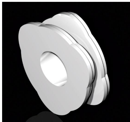
FIGURA 8.8: renderizado del cuarto engranaje junto con el plato de levas.
