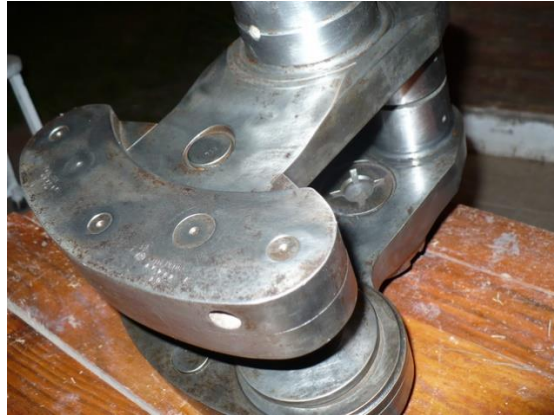
FIGURA 6.46: cigüeñal típico de motor radial, se aprecia la cavidad donde iría alojada la biela madre. (39)
