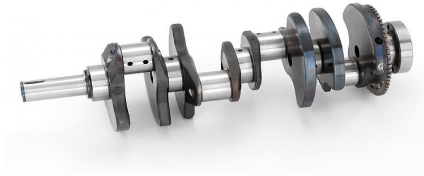
FIGURA 6.45: cigüeñal típico de un MCIA donde se aprecian perfectamente las excentricidades y los contrapesos. (39)
