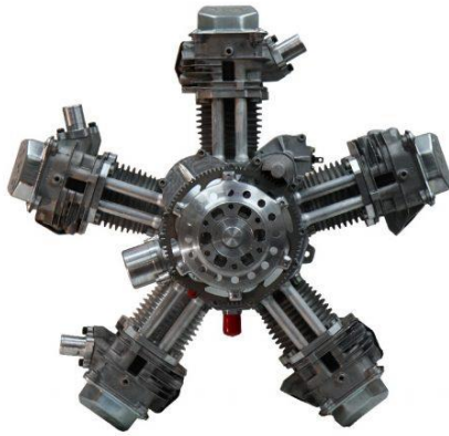
FIGURA 3.1: Imagen de un motor radial. Se puede ver la distribución de los cilindros con sus correspondientes aletas de refrigeración. Imagen extraída de: (3)
