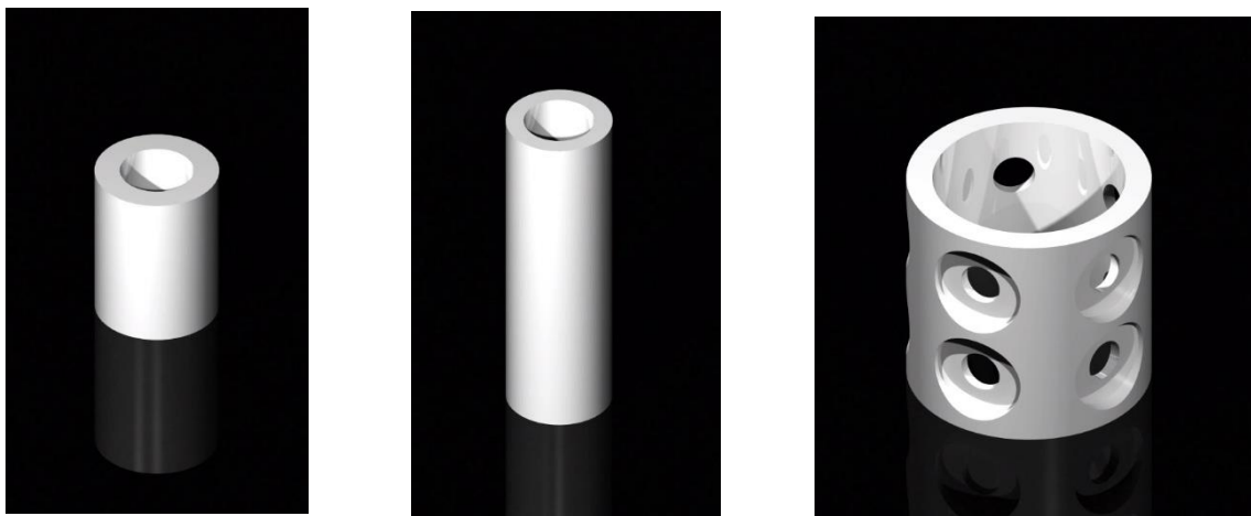
FIGURA 8.10: bulón biela-biela madre, bulón pistón-biela y casquillo de unión.
