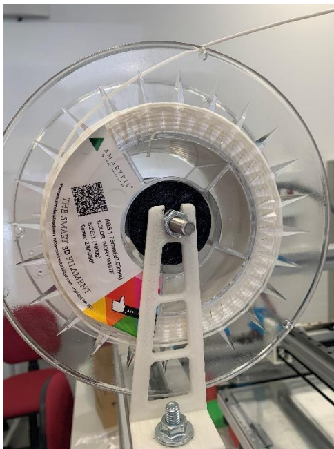
FIGURA 9.5: a la izquierda una bobina de ABS de color blanco con la que se hizo el cuerpo del motor. A la derecha PLA bobina que se utilizó para imprimir la biela y el bulón.
