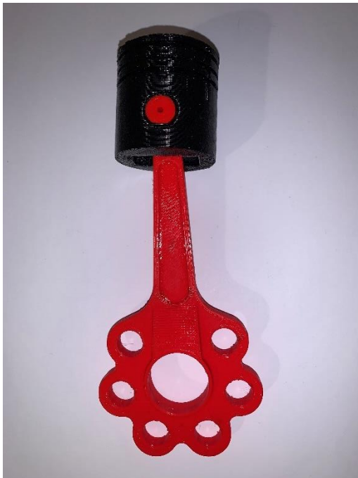
FIGURA 9.7: a la izquierda el ensamblaje de todas las piezas impresas. A la derecha el interior del pistón donde se ve el ajuste entre la biela madre, el sobre eje y el bulón de pistón.
