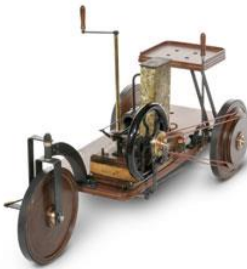
Ilustración 6. “Motrice Pia”, primer triciclo con motor de combustión interna de gasolina, creado por Enrico Bernardi .
