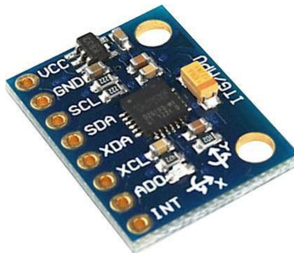
Figura 5.6: Acelerómetro y Giroscopio MPU6050
