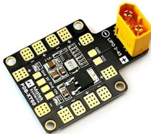
Figura 5.7: Placa de distribución de potencia con BEC y conector XT60
