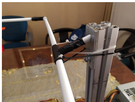
Figura 5.12: Figura del sistema de bridas que impide el giro
