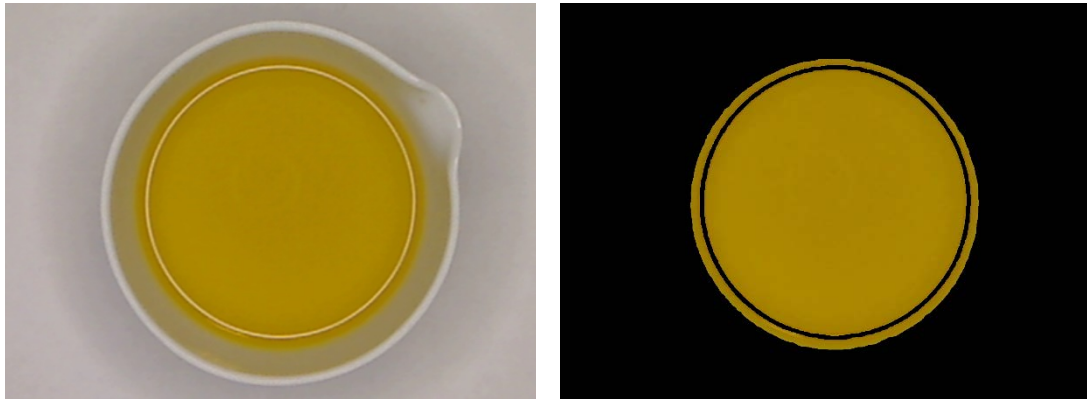
Figura 16. Imagen de muestra i0_06__12 segmentada (derecha) y sin segmentar (izquierda). Esta muestra tiene un contenido de impurezas del 0.06%
