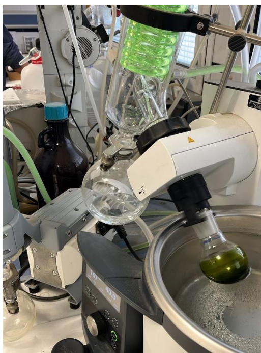
Figura 13.- Rotavapor Heidolph Hei-VAP. Las condiciones del equipo se consultan en una tabla facilitada por el fabricante.
