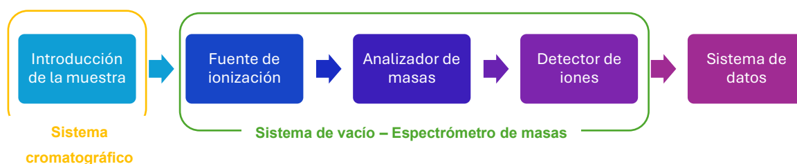
Figura 6.- Esquema general de un espectrómetro de masas (elaboración propia).
