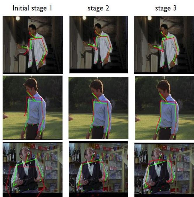
Figura 4.6 Iteración de DeepPose para una Mayor Precisión [11]
