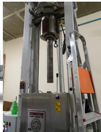
Figura 1: Equipo comercial para tratamiento a altas presiones (izquierda) modelo Wave 6000-55 (Mújica-Paz et al., 2011) y equipo de altas presiones para investigación usado en este estudio (derecha) modelo Iso-LabSystem FPG9400.922.
