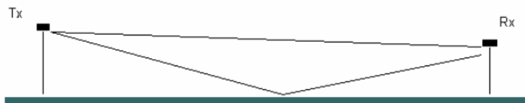
Ilustración 4-13. Esquema de reflexión utilizando dos rayos.
