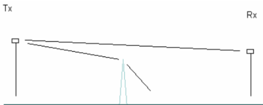
Ilustración 4-14. Esquema de cálculo del modelo de Fresnel
