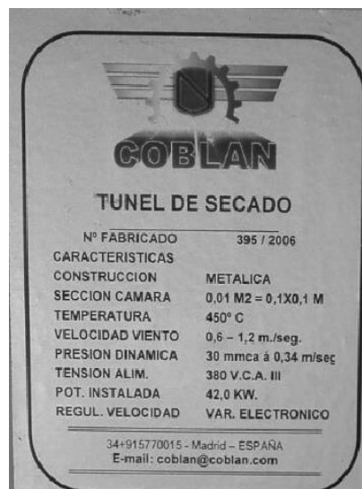
Ilustración 3: Especificaciones técnicas del túnel de secado
