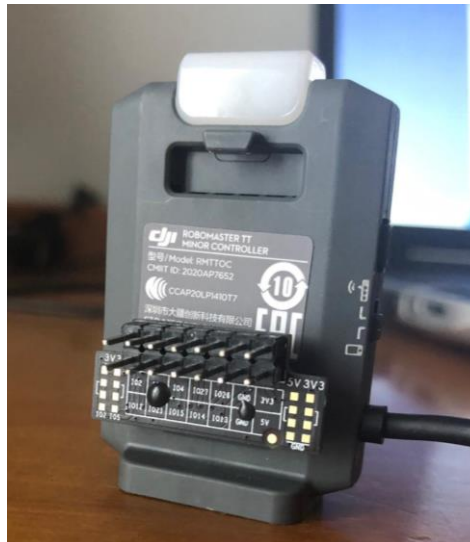
FIGURA 5.1-3 EXTENSION BOARD CON SOLDADURA DE PINES MACHO Y CONECTADO AL EXPANSION KIT
