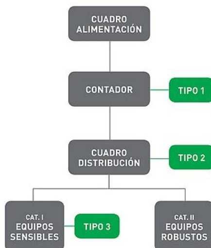
Figura 34 – Tipos de protección frente a sobretensiones 3
