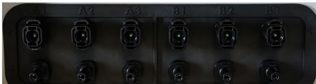
Figura 26 – Detalle de las entradas del inversor
