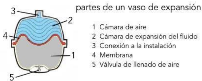
Figura 29: Partes de un vaso de expansión
