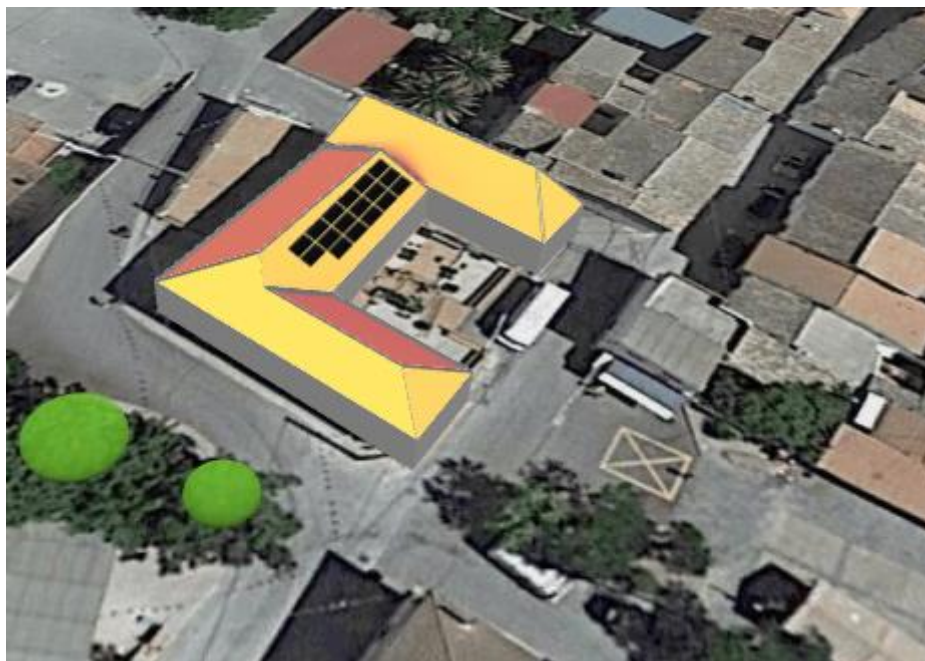
ILUSTRACIÓN 48: instalación módulos(FUENTE: Programa Solar Edge)
