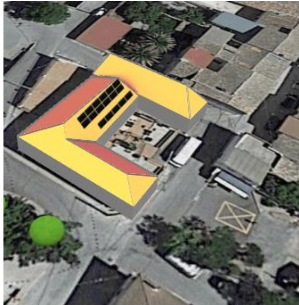
ILUSTRACIÓN 60: Instalación de módulos (FUENTE: Solar Edge)
