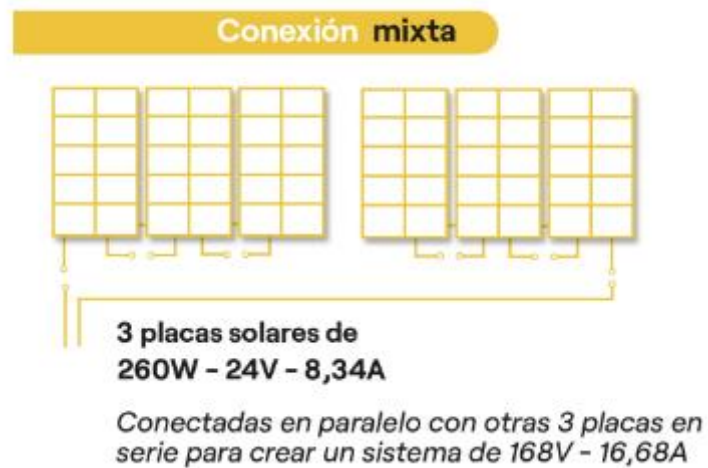
ILUSTRACIÓN 8: Conexión mixta (FUENTE:Sotysolar)
