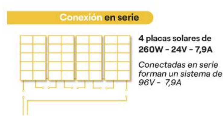
ILUSTRACIÓN 6: Conexión en serie (FUENTE:Sotysolar)
