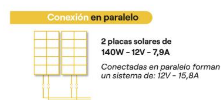
ILUSTRACIÓN 7: Conexión en paralelo (FUENTE:Sotysolar)
