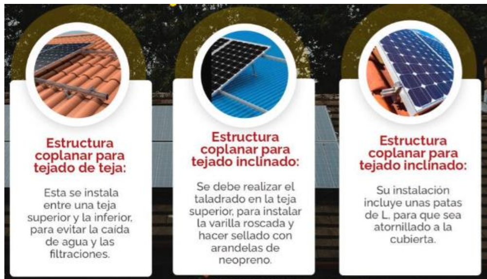
ILUSTRACIÓN 10: Paneles sobre tejado inclinado (FUENTE:Solarama)
