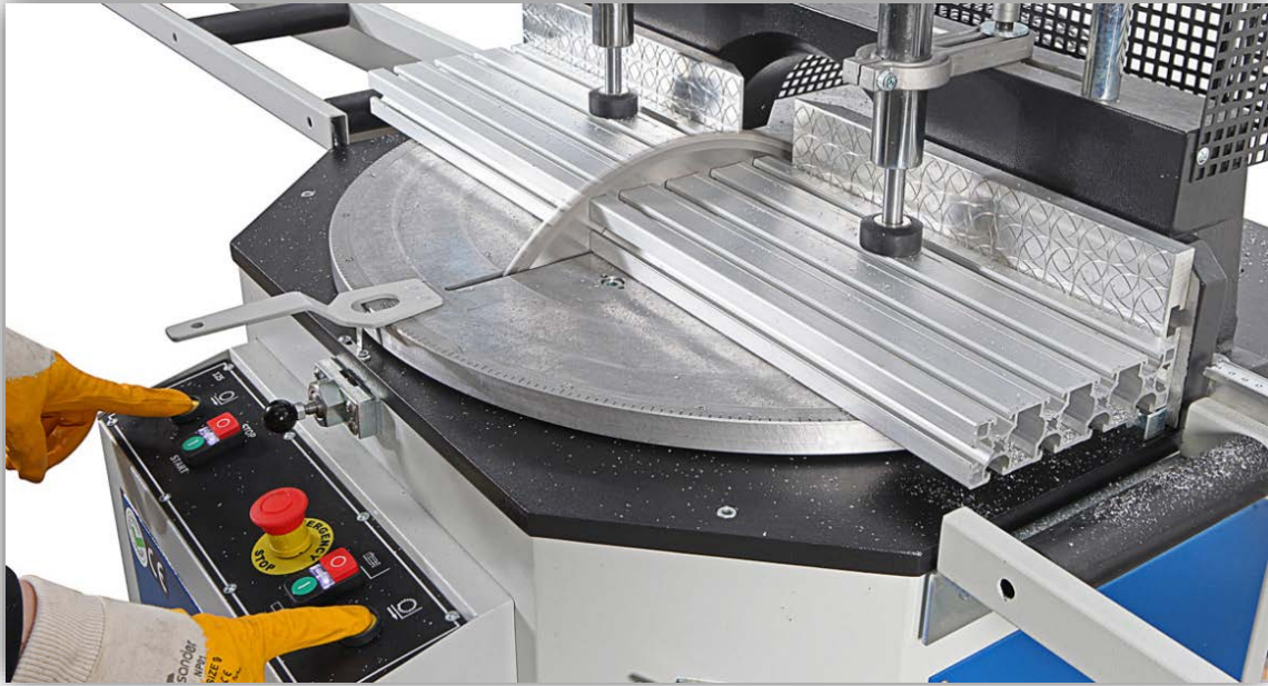
Fotografía 7.4. Sierra circular de mesa automática. Fuente [21]
