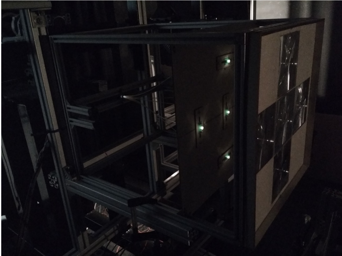
Fotografía 9.1. Prototipo fabricado del módulo de fibra óptica correctamente alineado en la parrilla del simulador solar.
