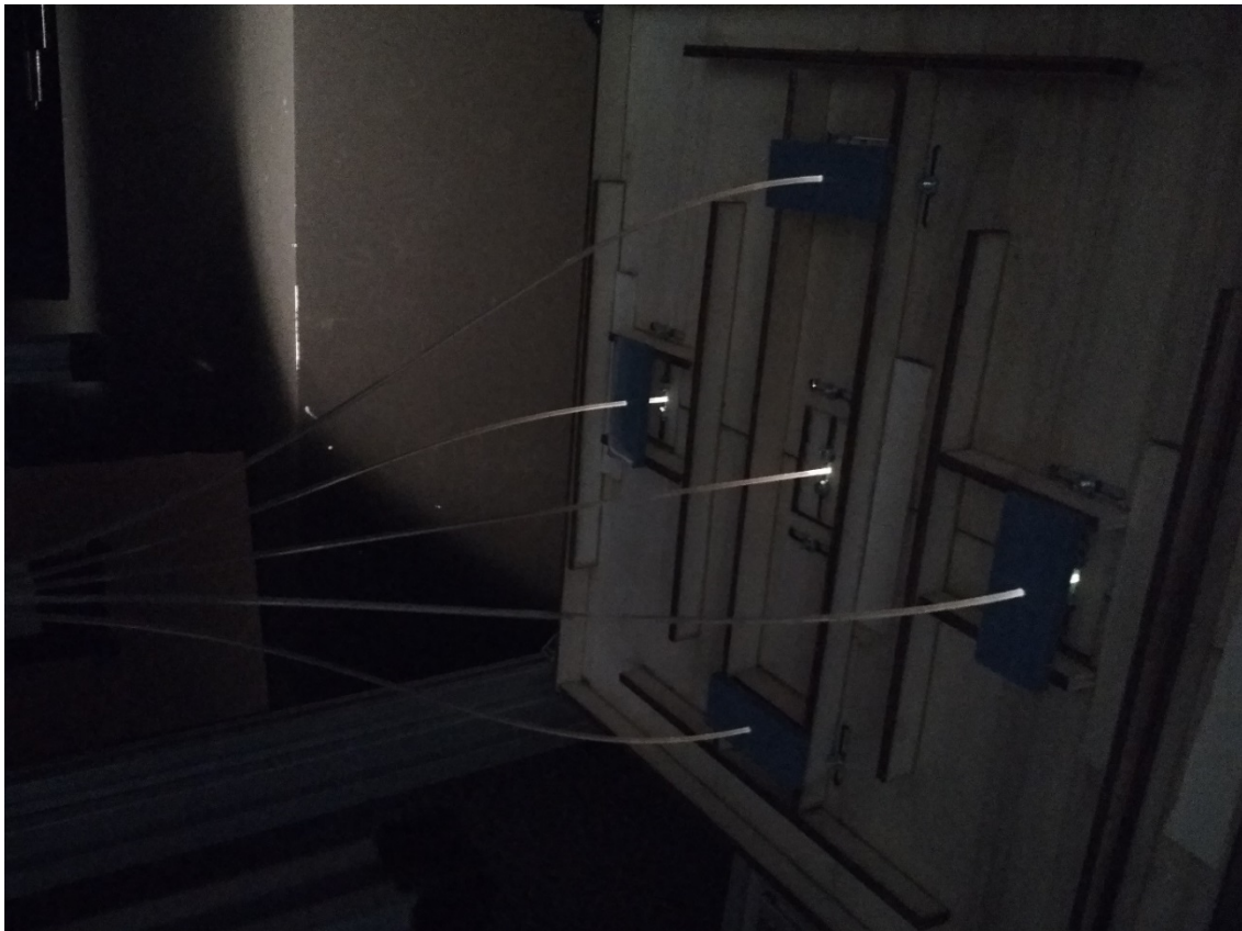
Fotografía 9.2. Detalle de la luz entrante en las fibras.
