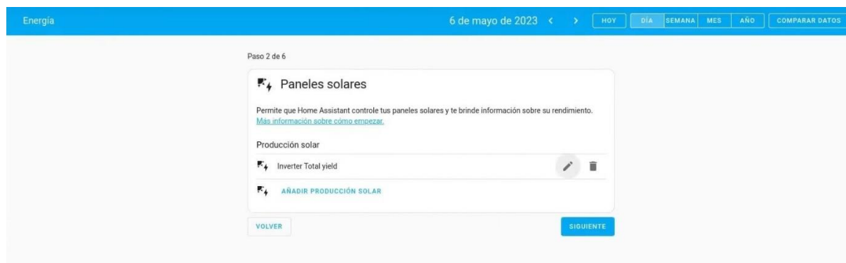
Figura 6.2.3.7: Integración de inversor
