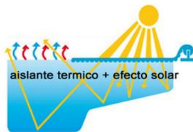
Fig. 4-93 Ejemplo instalación y funcionamiento manta térmica solar para climatización piscina [36]
