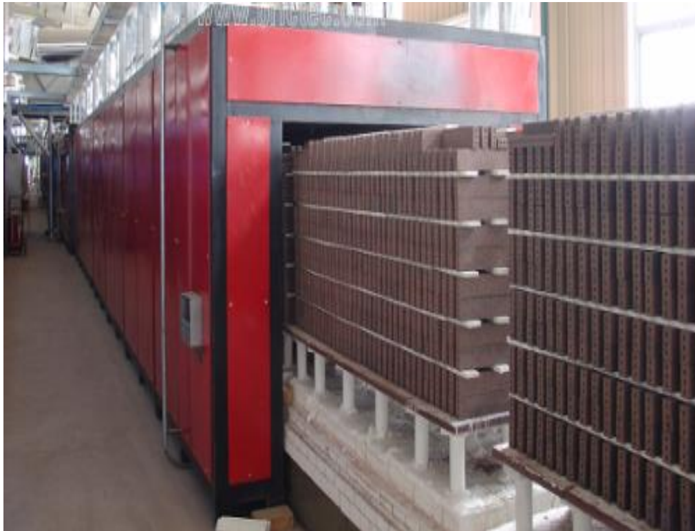
Ilustración 6: Ladrillos saliendo del horno túnel. Fuente: https://www.solostocks.cl/venta-productos/maquinaria-fabricar-materiales-construccion/maquinas-fabricar-ladrillos/horno-de-tunel-para-quemar-ladrillo-grande-suramerica-1543743
