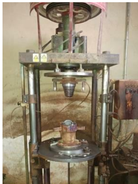
Ilustración 12: Máquina rotativa para fabricación de macetas. Fuente: Archivo fotográfico del autor.
