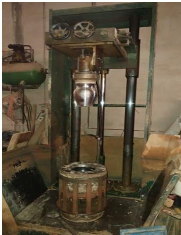
Ilustración 13: Maquina Rolex para fabricación de macetas con grabados. Fuente: Archivo fotográfico del autor.
