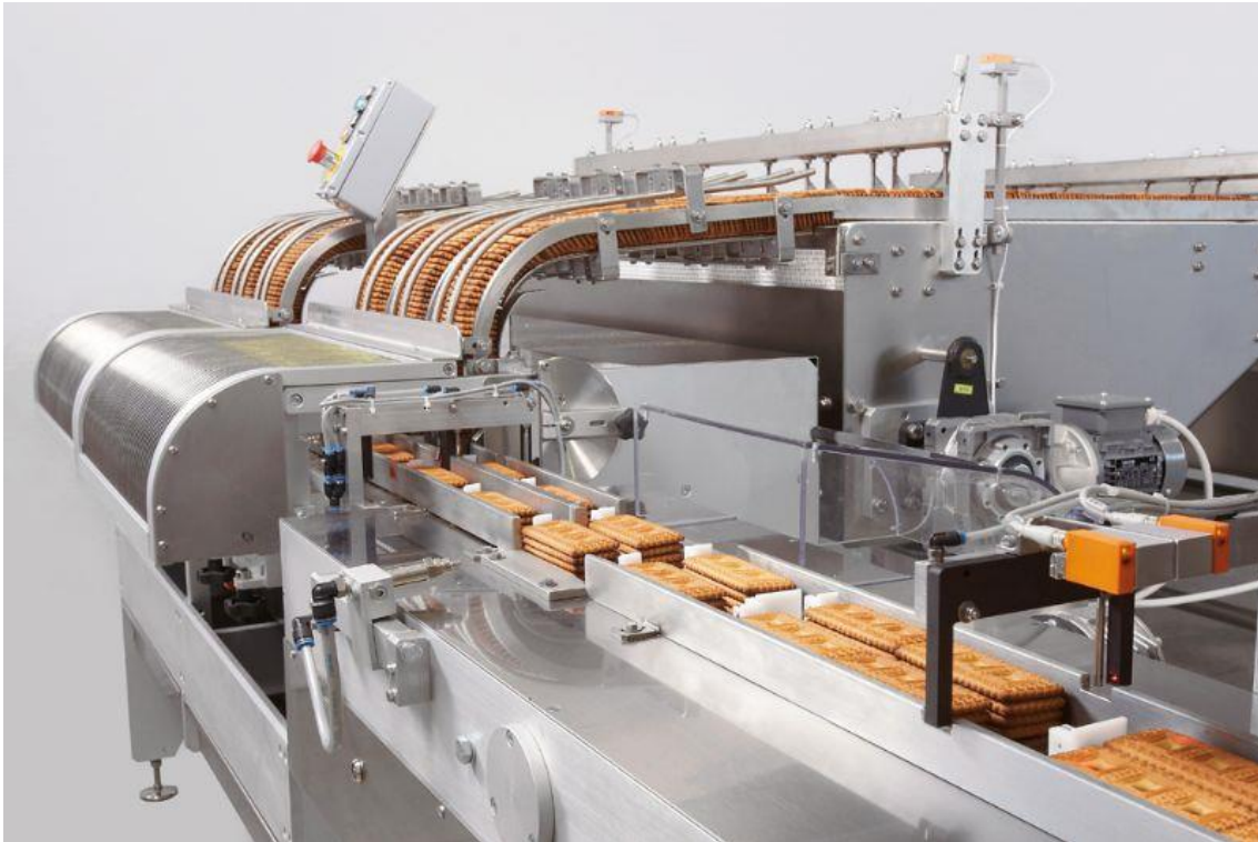
Figura 5.13: Funcionamiento de los cargadores. Fuente: (Tecno Pack Spa)
