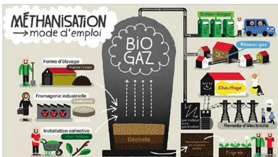
Figura 29 - El proceso de digestión anaeróbica
