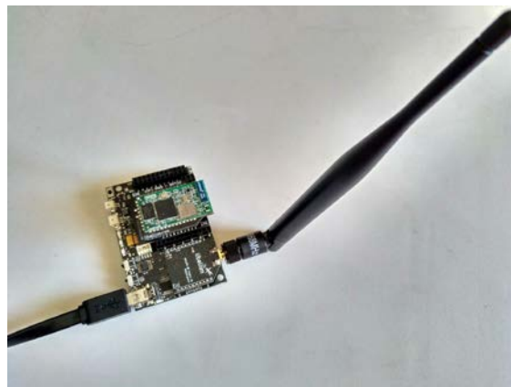
Imagen 4.1.2.4. Sensor Wasmote con módulos LoRa, WiFi PRO y placa radio de expansión conectados.
