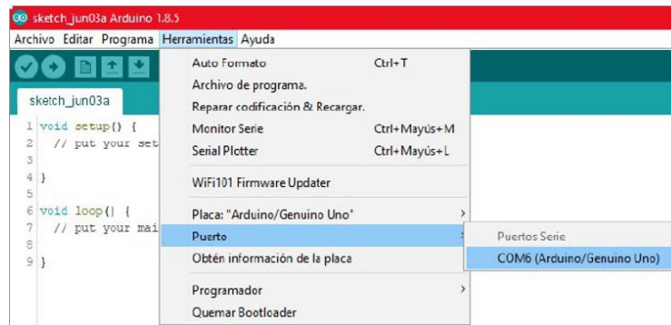
Imagen 4.2.2.9. Selección de puerto en la placa Arduino.
