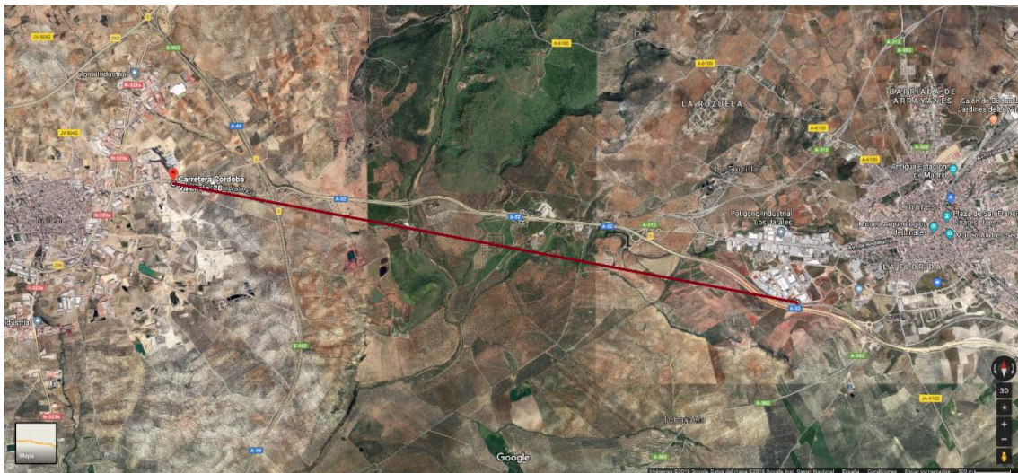
Imagen 5.1.2.1.1. Distancia entre los dos puntos donde se produce comunicación entre Linares y Bailén mediante el módulo LoRa.
