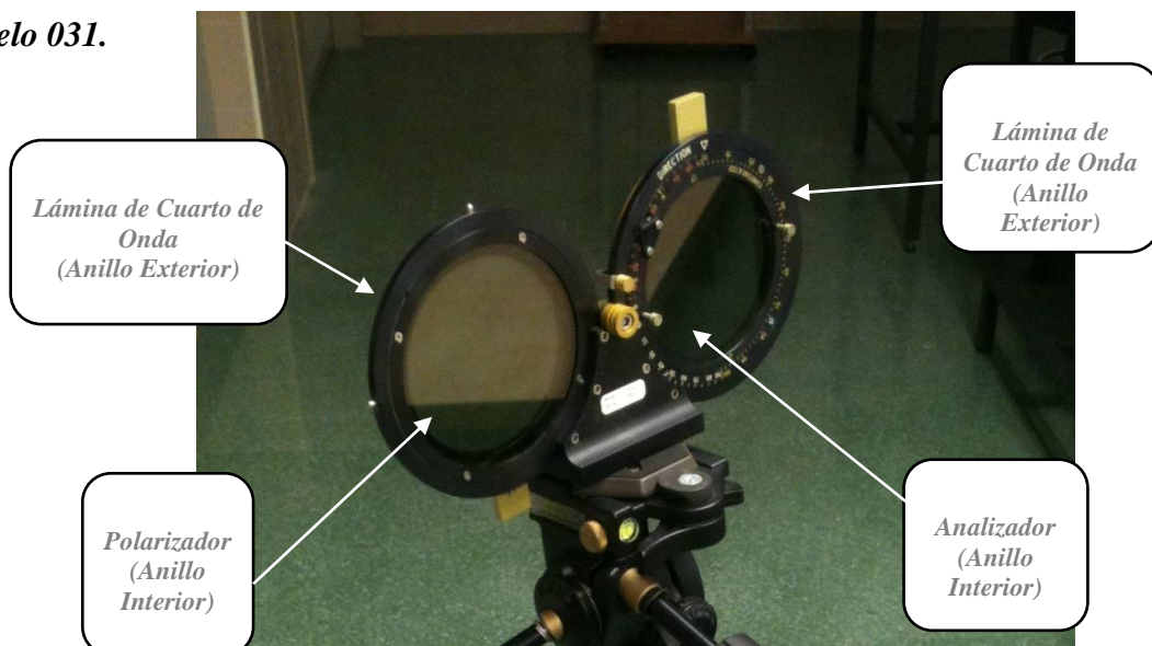
Figura 22.- Posicionamiento del Analizador, Polarizador y Láminas de Cuarto de Onda del Polariscopio Real de reflexión Modelo 031
