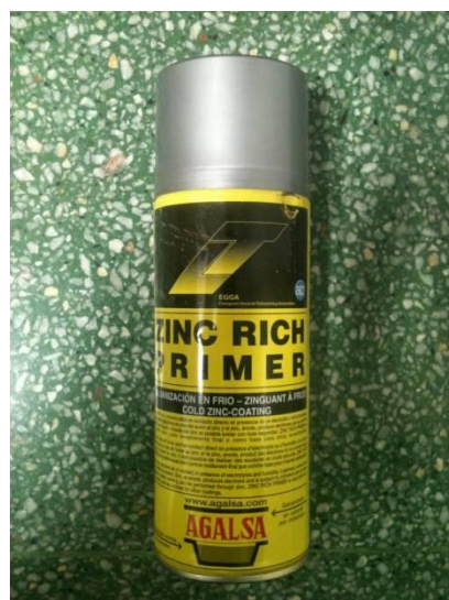
Figura 23.- Pintura Plateada, de la marca AGALSA, usada para pintar las piezas ensayadas
