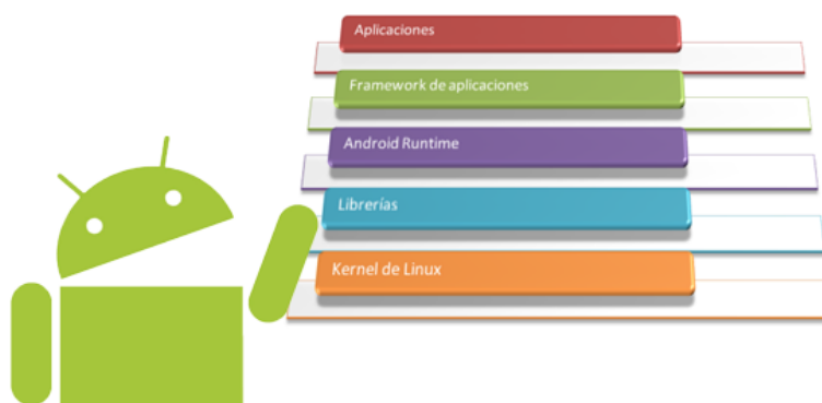
Ilustración 2.7. Esquema con las diferentes capas de Android.
