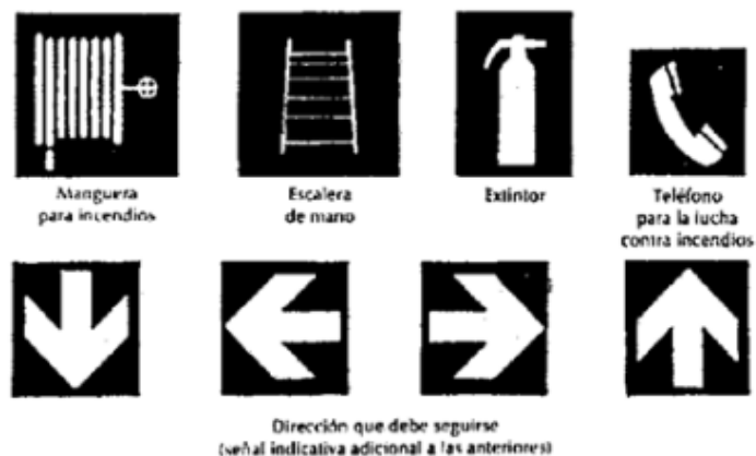
Imagen 34 – Señales de equipos de lucha contra incendios
