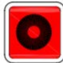
PULSADOR DE ALARMA
