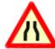
TP-17 ESTRECHAMIENTO DE CALZADA
