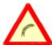
TP-13A CURVA PELIGROSA HACIA LA DERECHA
